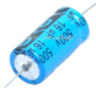
Calculer l'énergie stockée dans le condensateur ci-dessus polarisé sous 230V dont la capacité est de 16μF.
